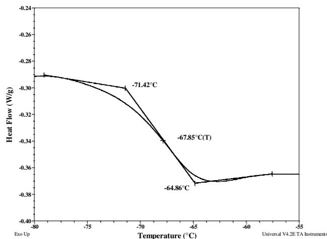
**Melting curve for DMS block:**
