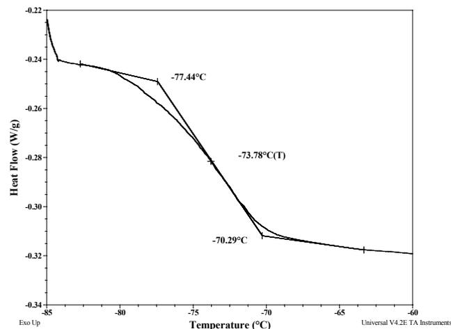
**Melting curve for DMS block:**
