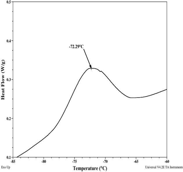
**Melting curve for DMS block:**
