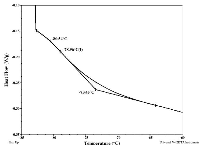
**Melting curve for DMS block:**
